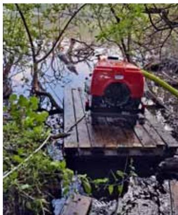
wässer nah genug an das Wasser stellen zu können, wurde von der FF Mielkendorf durch das pragmatische Umfunktionieren eines alten Bootssteiges zu einem Schwimmponton gelöst, siehe Bild.
